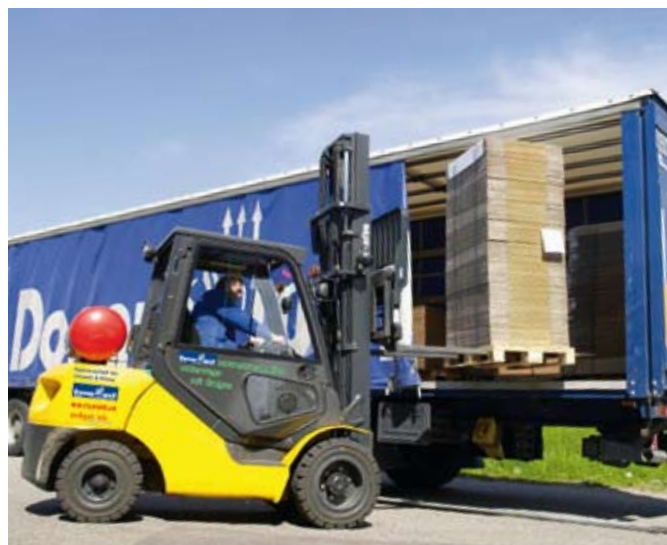
Die Firma Donauwell in Naarn nutzt Erdgas nicht nur zum Heizen, sondern auch als Treibstoff für Hubstapler. Dadurch gibt es keine Staubbelastung in den Lagerhallen und saubere Luft für die Mitarbeiter.
